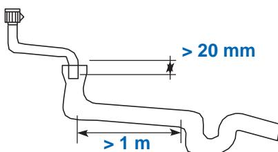
Шланг сброса давления от электропривода вставьте в верхнюю выемку патрубка для трубы или наклонное отверстие наконечника для шланга.
