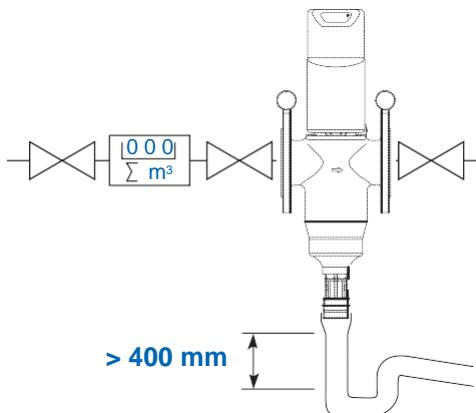
Установить на трубопровод запорные клапаны (поставка Заказчика) до и после фильтра.
