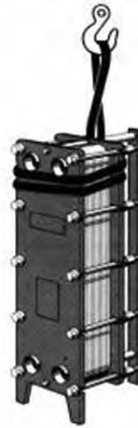
Строповка теплообменника без транспортных отверстий
